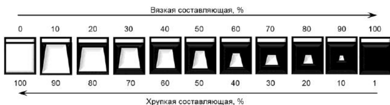
Рисунок Г.2 - Шкала определения вязкой составляющей в изломе ударного образца
